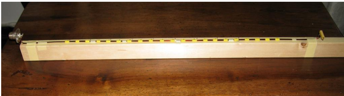
Fig.7 – Una delle linee bifilari fissata all'asse di legno che fa da supporto per facilitare l'esecuzione della misura di impedenza caratteristica. A sinistra il connettore di collegamento all'MFJ-269, a destra la resistenza di carico variabile.
