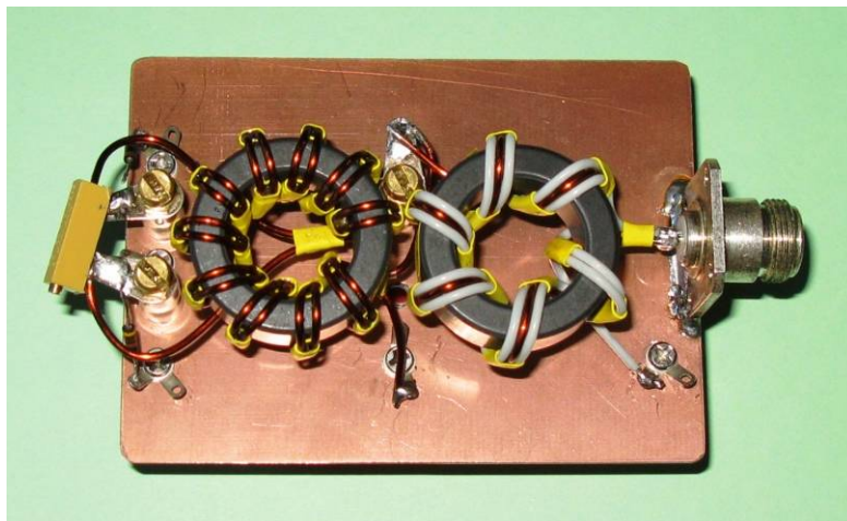
Fig.21 – Trasformatore sbilanciato (unun) 1:2 saldato al test-jig di misura.
