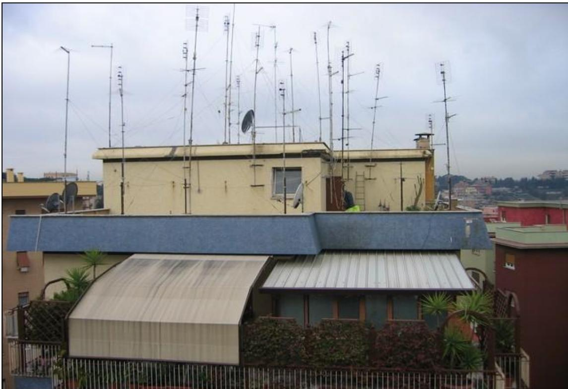
Se un fulmine impatta sull'edificio tutte le antenne presenti sulla copertura, comunque comprese nell'area di una sfera di raggio 20 metri, saranno interessate dagli effetti dell'induzione elettromagnetica, con danni più o meno gravi dipendenti dal percorso dei cavi dal tetto fino all'utenza.
