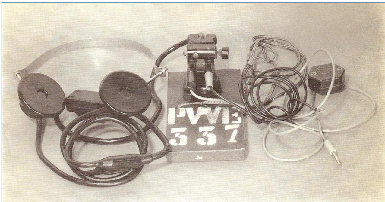
*La cuffia sulla sinistra è di fabbricazione italiana. Il cordone della medesima è invece del tipo militare americano “US Army Signal Corps”, forse sostituito per inefficienza di quello originale. La “radio” consiste in una presa tripla a spina da 6 Amp. sorretta da una presa da parete, dello stesso passo, in bachelite.*
