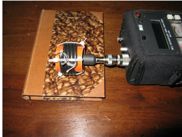
Fig.7 – Posizione tipica del probe collegato all'analizzatore d'antenna MFJ-269 rispetto alla trappola per la misura della frequenza di risonanza con il metodo del grid-dip meter.
